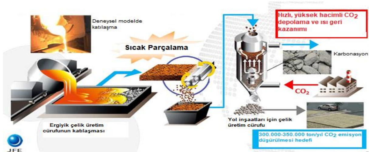
Şekil. Çelik Üretim Cürufundan Isı Geri Kazanımı Proses Şematüğü
