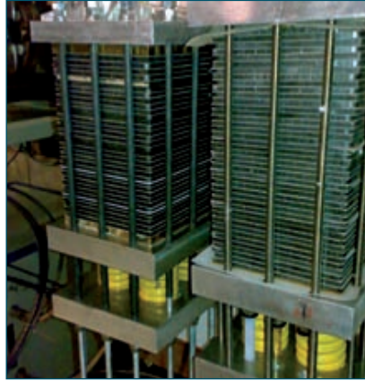
Membran elektrot ünitesi ile 1.5'er kW'lık 2 PEM tipi modülü
